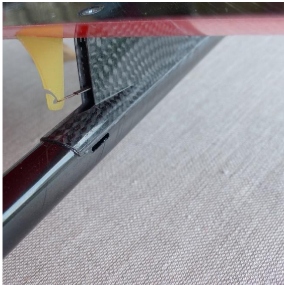
faire une fente pour la commande de la dérive
