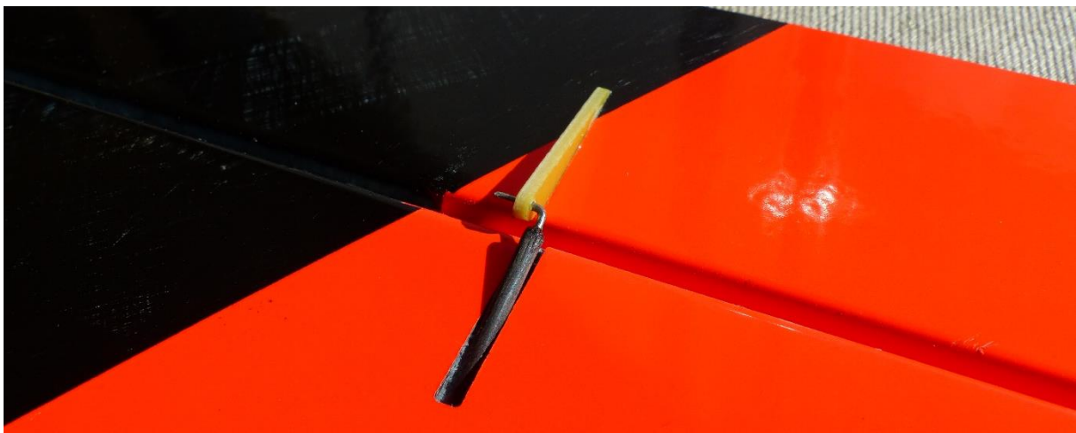
Commande des ailerons en place
